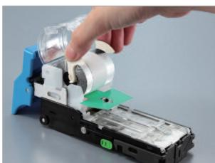
Einfach austauschbares Flachklammernmagazin mit 4.000 Flachklammern.
