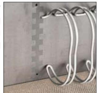
ein „Kamm“ erleichtert das Befüllen des Drahtes mit Papier
